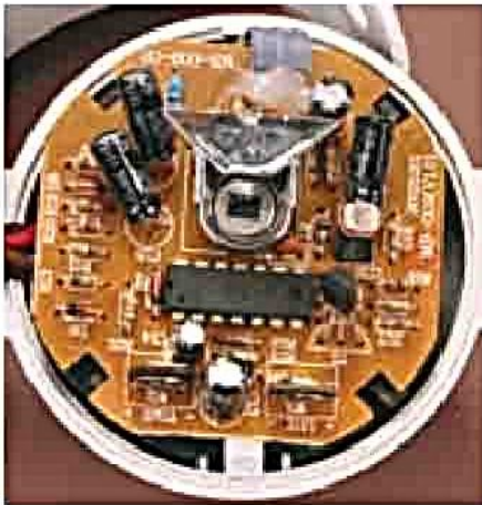
شکل ۵-۴۲ اجزای داخلی (PIR)
