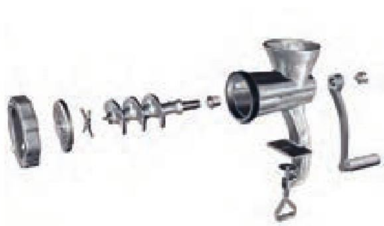
شکل ۶۷- تصویر سه بعدی انفجاری چرخ‌گشت دستی
