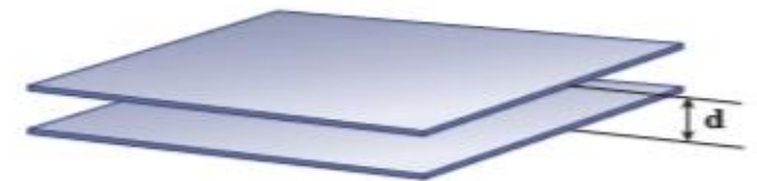
شکل ۳- یک خازن تخت، از دو صفحه با مساحت A ساخته شده است که به فاصله d از هم قرار گرفته‌اند.
