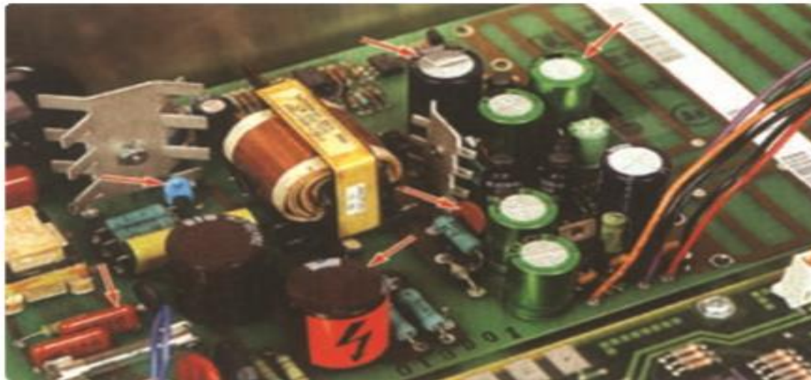
شکل ۴- مدار یک تقویت‌کننده که شامل چند خازن است. برخی از خازن‌ها با پیکان مشخص شده‌اند.
